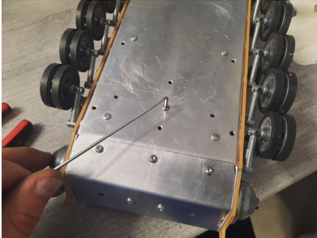
7. Nun die Abdeckung anschrauben und die Antriebsräder Montieren (Kegelzahnräder können gefettet werden).
