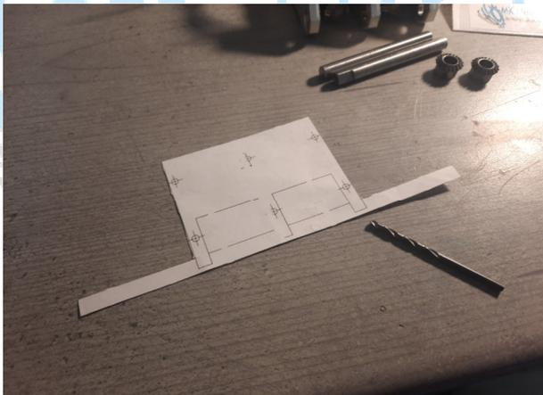
2. Schablone mittig in der Längsrichtung und so das die Achsen die Exakte Position haben aufkleben und die Bohrungspunkte markieren.
