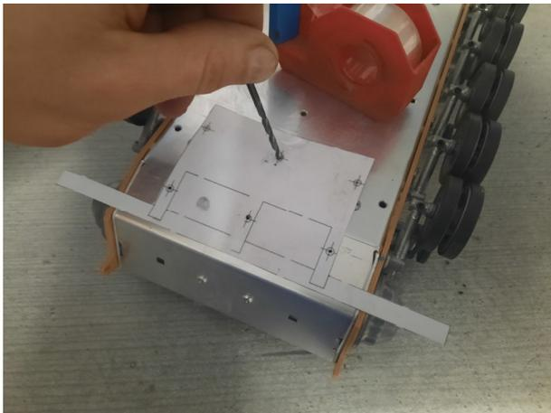
3. Die Markierten Bohrungen nun mit einem 3mm Bohrer bohren und Senken (ggf einzelne Bohrungen weg lassen Modell abhängig) Drauf achten das keine Beschädigungen im Modell entstehen beim Bohren (Steuermodule usw.) !
