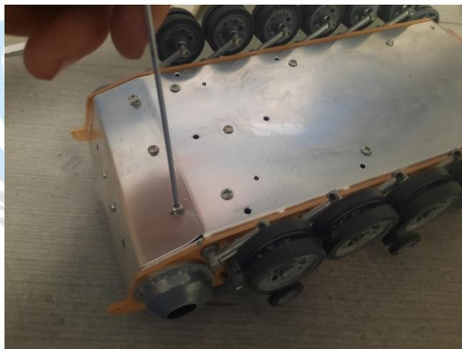
5. Achsen und Kegelzahnräder einsetzen, und entsprechend verschrauben.
